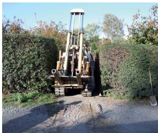
MIP sondering met mini rups
